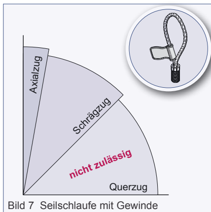
Bild 7 Seilschleife mit Gewinde
